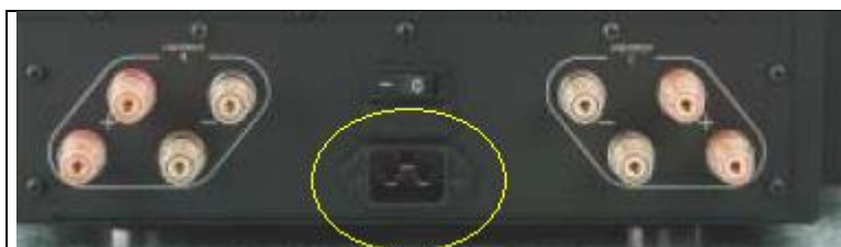
La presa di rete DIN tripolare da pannello. Presente sul pannello posteriore dell' Unico 200 (evidenziata dal cerchio giallo).
